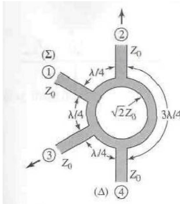
$$[S] = \begin{bmatrix} 0 & -jy_2 & -jy_1 & 0 \\ -jy_2 & 0 & 0 & jy_1 \\ -jy_1 & 0 & 0 & -jy_2 \\ 0 & jy_1 & -jy_2 & 0 \end{bmatrix} = -j \begin{bmatrix} 0 & \alpha & \beta & 0 \\ \alpha & 0 & 0 & -\beta \\ \beta & 0 & 0 & \alpha \\ 0 & -\beta & \alpha & 0 \end{bmatrix}$$
